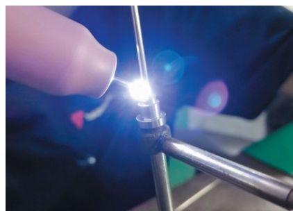
◀直径2ミリの精密溶接
